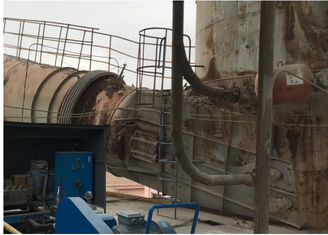
图 1 原三次风管与分解炉连接方式
