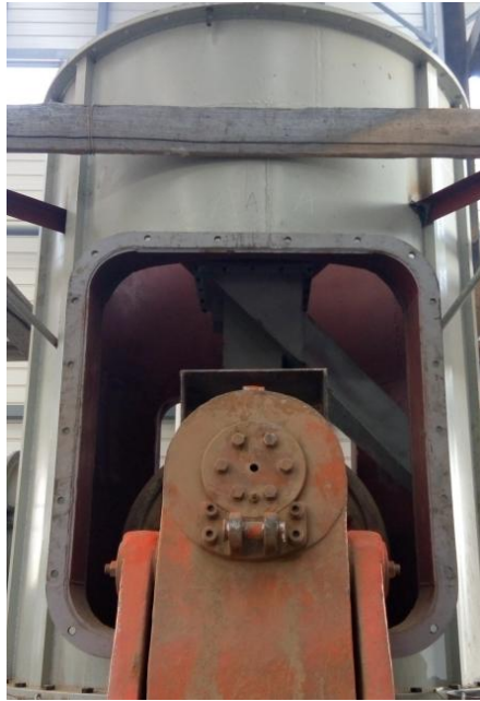
图 3-灰斗裙式集料外排装置实物图
