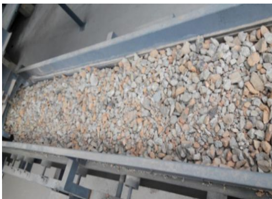
图 6-废砖瓦和废混凝土混合料
